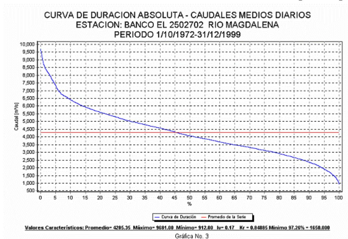
Para calcular el índice de variabilidad se leen en la curva construida los caudales a diferentes porcentajes y para adelantar el análisis se construye la tabla 3.3 para ingresar los valores.
